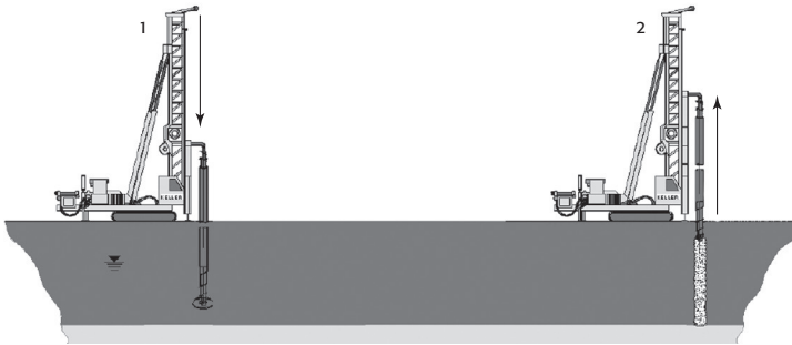
Figure 5.1 Réalisation d'une inclusion rigide avec une tarière à refoulement (source : Keller)
