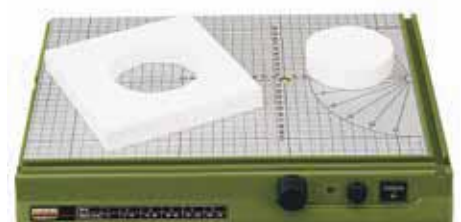
Une solution simple et efficace pour découpes circulaires: fixez une punaise retournée sur le plateau à l'aide de ruban adhésif. Elle sert ensuite d'axe central.
