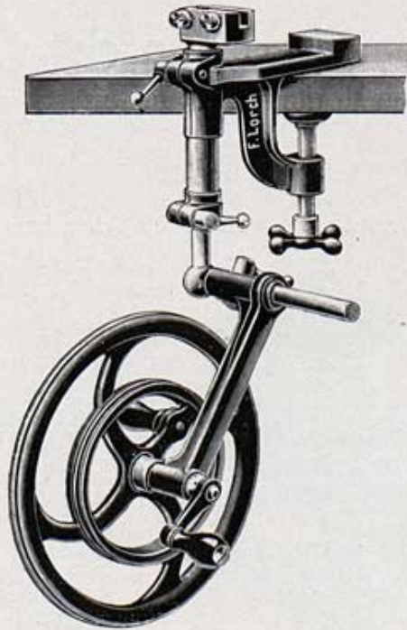
No. 3. Handrad „Lorch“ für Werk Tisch . Mk. 11.75 (Gleichzeitig für links und rechts verwendbar)
