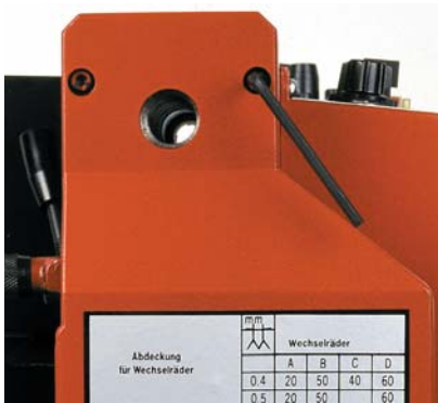
Démontez le capot d'engrenage
