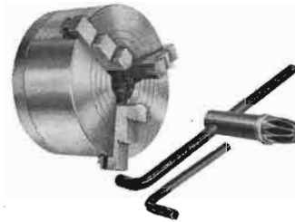
160-20.065 Dreibackenfutter Reishauer Typ UF, \varnothing 160 mm, mit konzentrisch spannenden Backen, umkehrbar für Innen- und Aussen-spannung, mit: – 1 Satz harter Grundbacken – 1 Satz weicher Aufsatzbacken – 1 Satz harter, gestufter und umkehrbarer Backen Rundlaufgenauigkeit mit hartem Backen: 0,015 mm Gewicht: 14,300 kg
