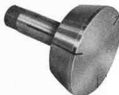
Vorbearbeitete Stufenfutter Typ B-32 40a-396 Grösse 1 für \varnothing 20-60 mm Gewicht: 1,360 kg 40a-397 Grösse 2 für \varnothing 60-100 mm Gewicht: 2,100 kg 40a-398 Grösse 3 für \varnothing 100-140 mm Gewicht: 5,360 kg 40a-399 Grösse 4 für \varnothing 140-180 mm Gewicht: 8,620 kg
