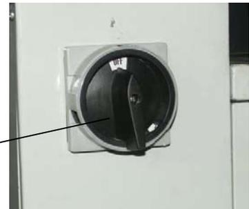
Fig. 1-1: Interrupteur principal
