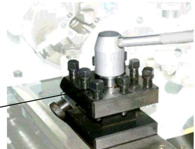
Mettre l'outil à hauteur de pointe. utiliser la poupée mobile équipée d'une pointe fixe afin de la contrôler. Mettre, au besoin, des cales en acier sous l'outil pour régler la hauteur.
