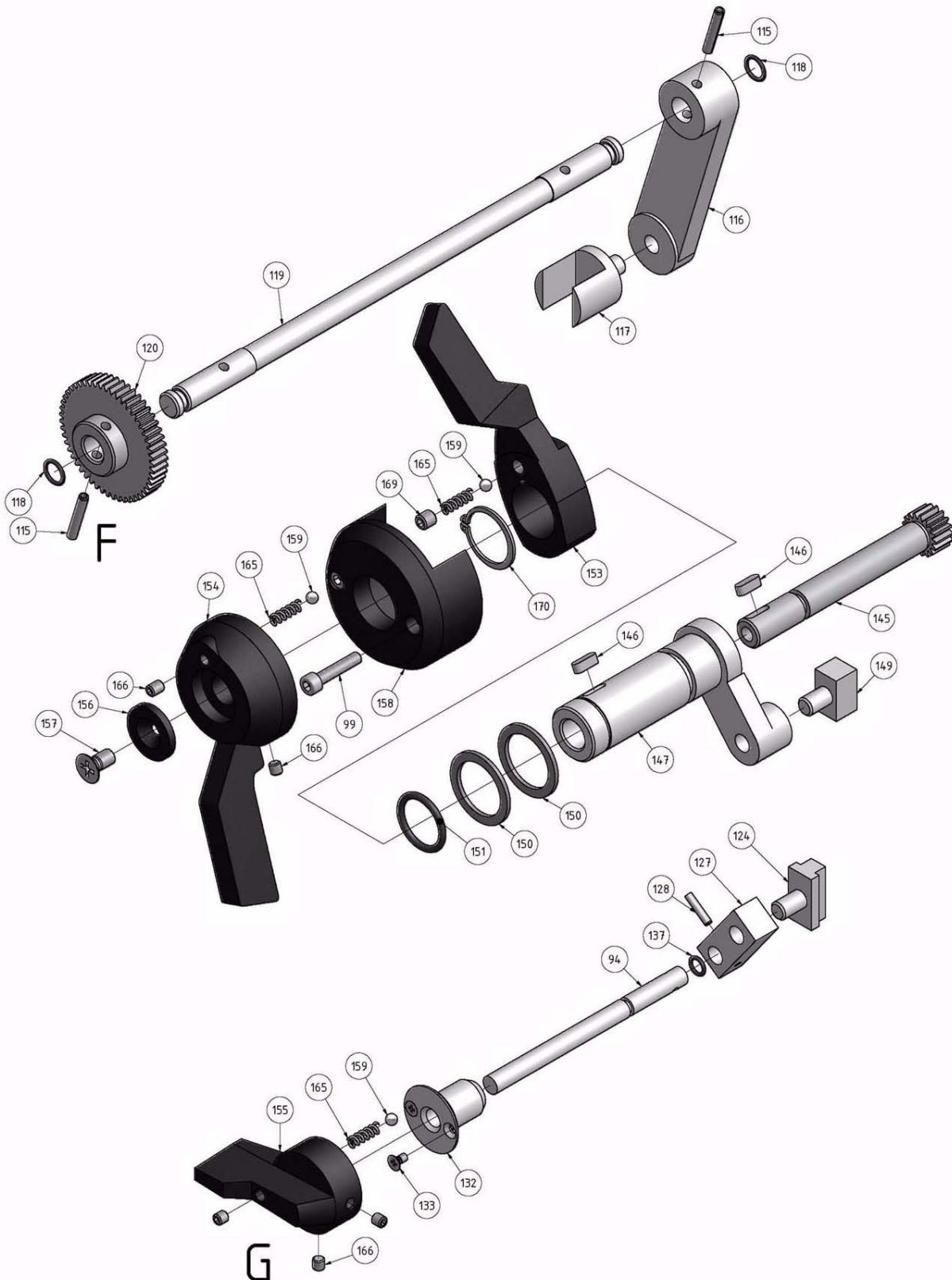
Abb.9-10: Getriebe Spindelstock 6-6 - Headstock gear 6-6
