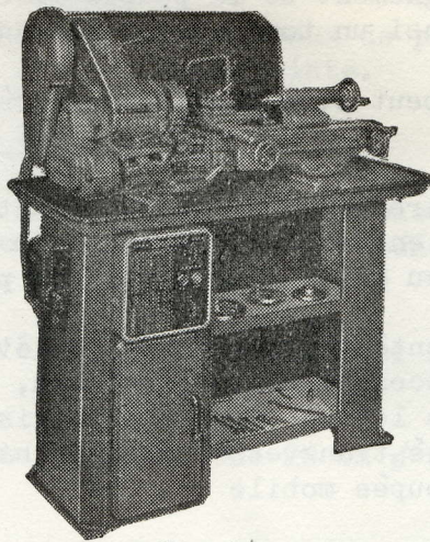
Fig.14 Tour Super 7B monté sur socle industriel avec dispositif d'arrosage et rabat-eau.
