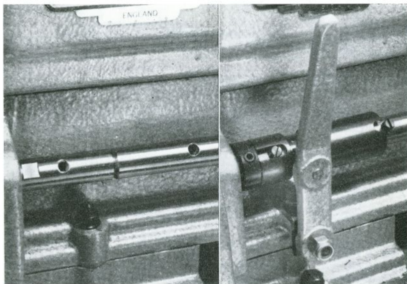
Abb. 8 Gezeigt sind die normale Leitspindel und die Leitspindelkupplung.
