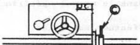
4 butées longitudinales sont situées sur une barre de butées fileté. Pour régler une butée, desserrer la vis A, positionner le corps de butée, resserrer légèrement la vis A, terminer le réglage en tournant la vis B, et enfin bloquer fortement la vis A; Le passage d'une butée à l'autre se fait par un mouvement de va-et-vient de la poignée C.
