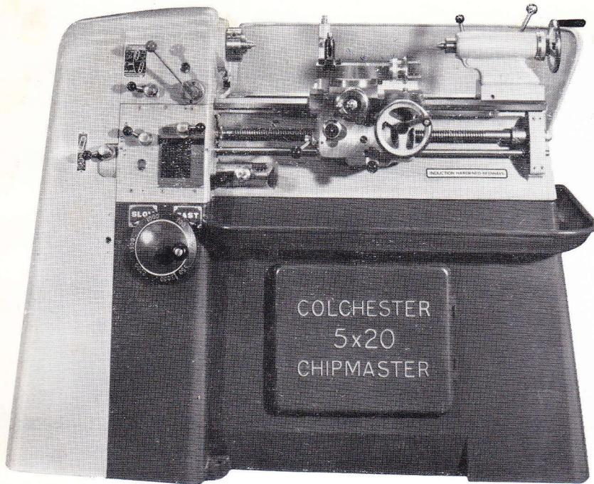
Le tour Colchester Chipmaster est une machine rigide et compacte. Le tour est équipé d'un variateur de vitesse de broche infiniment variable, sans vibrations, et permettant l'utilisation de grandes vitesses nécessaires pour l'usinage de petites pièces précises qui demandent une excellente qualité de finition.
