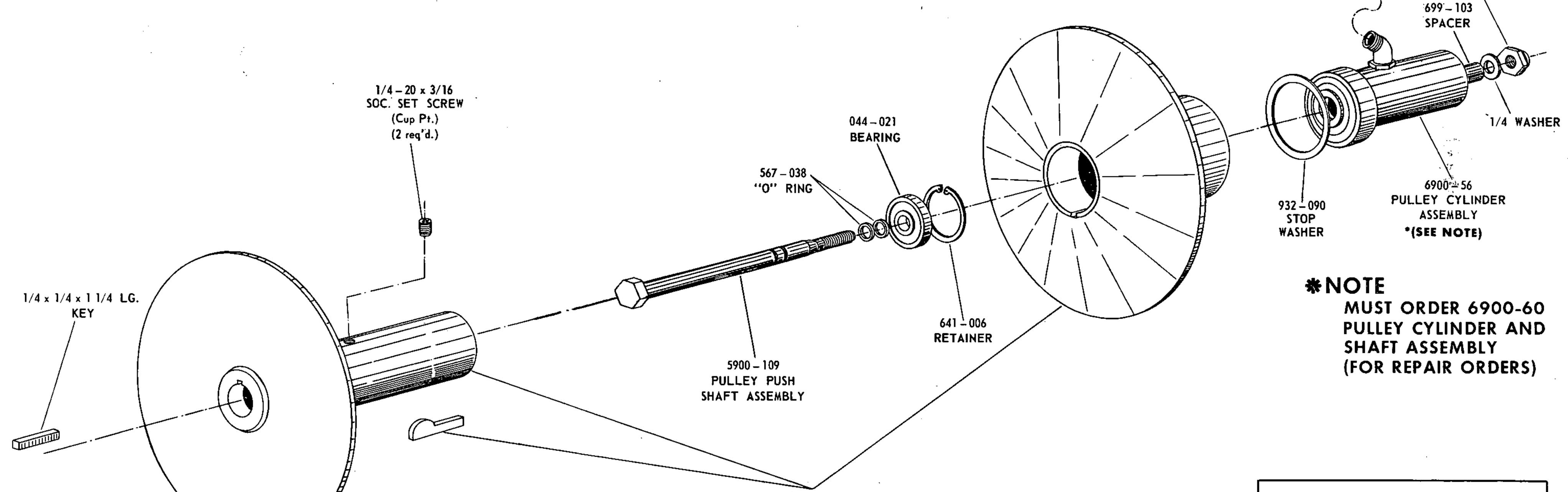
MOTOR VARI. PULLEY ASSEMBLY
